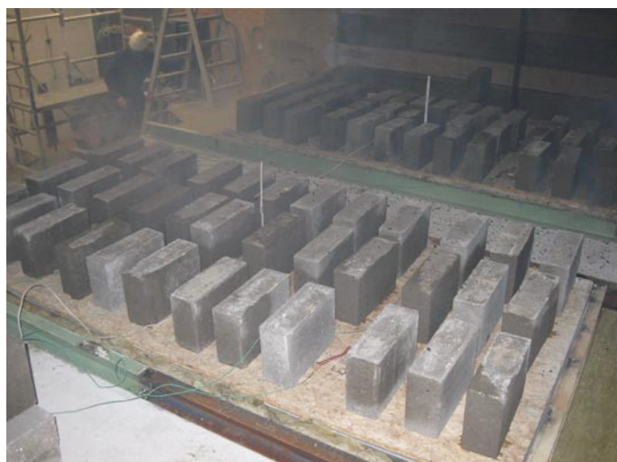
58. Brandproeven uitgevoerd door TNO met Star-Frame vloeren.
